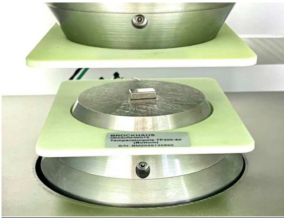
Abbildung 5: MIM-Magnet im Hysteresegraph zur magnetischen Charakterisierung
